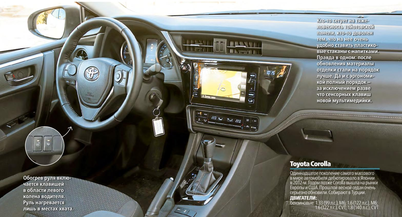
Обогрев руля включается клавишей в области левого колена водителя. Руль нагревается лишь в местах хвата.
