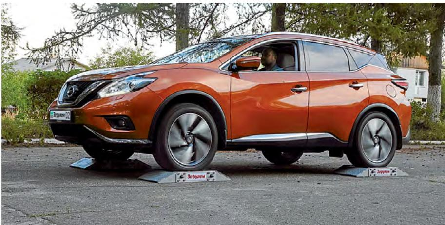
Murano едва не выбыл из игры, как только на роликах оказалось одно переднее колесо. На малом газу он не делал попыток тронуться, а через полминуты известил о перегреве трансмиссии. При повторном заезде спустя пару минут межосевую муфту удалось пробудить к жизни резкой подачей газа: Nissan выбрался из ловушки. И повторил этот подвиг при диагональном расположении роликов.
