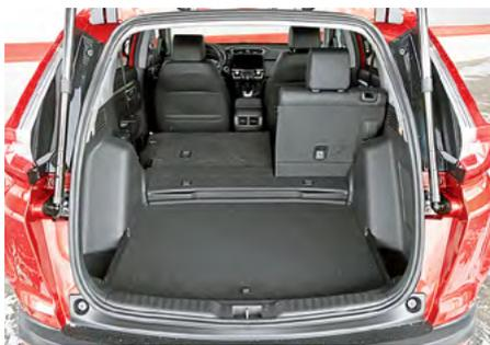
Багажный отсек старого CR-V вмещает 589 литров. У новичка – на шестьдесят больше. Пол можно установить выше, вровень с порогом и сложенной спинкой заднего сиденья. Электропривод пятой двери дополнен функцией ограничения высоты открывания.
