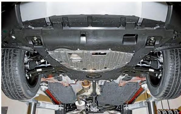
Моторный отсек прикрыт пластиковым пыльником со стальной тонкостенной вставкой. От серьезных механических повреждений такая не уберезет, только от пыли и грязи.
