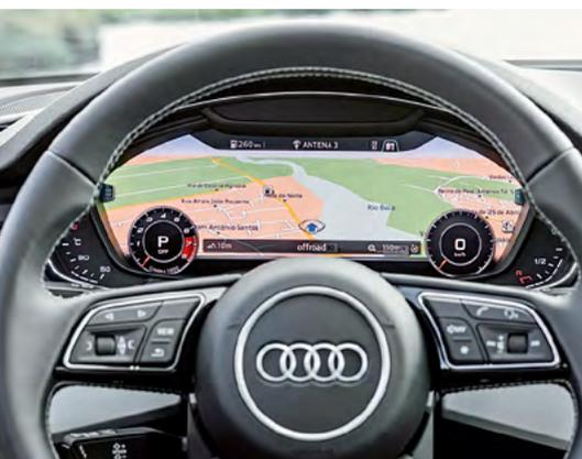
Впервые купе оснастили виртуальной приборной панелью Audi Virtual Cockpit. Это 12,3-дюймовый дисплей с разрешением 1440 на 540 пикселей. Картинку на экране можно задавать по своему усмотрению.
