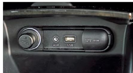
Под рядом клавиш, упруго подающихся при включении обогревов руля и сидений, а также вентиляции кресел, – разъемы USB и AUX.
