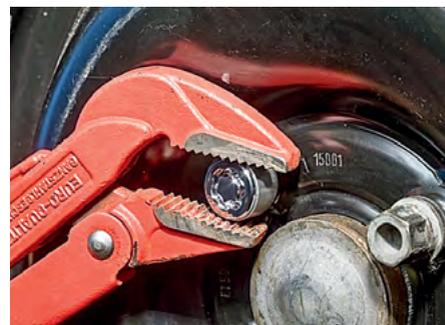
Жулики часто используют так называемый метод простукивания – лупят молотком по секреткам, пытаясь таким образом ослабить их затяжку. Проверим, работает ли метод. Момент затяжки – 100 Н·м **1**. Стучим молотком по секретке **2**. После простукивания измеряем момент отвинчивания. Он действительно уменьшился – до 80 Н·м **3**.
