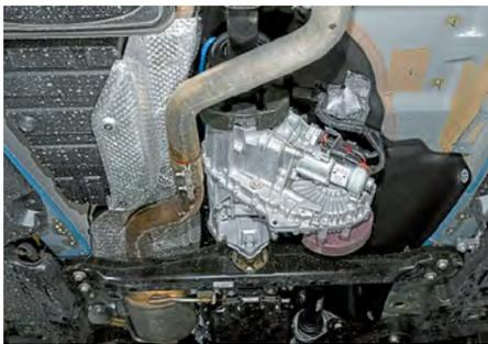
У Туарега защита раздатки «плавает» в пределе полутора сантиметров, демпфируя удары. А рёбра на баке добавляют прочности.
