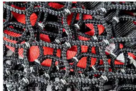
В протекторной части сеток закреплены металлические зажимы, цепляющиеся за лед.
