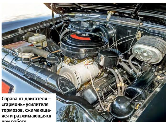
Справа от двигателя – «гармонь» усилителя тормозов, сжимающаяся и разжимающаяся при работе.
