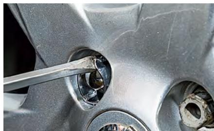
↑ Защитная втулка спасает от захвата трубным ключом, но может сослужить плохую службу перед грубой силой. Втулка сдалась – результат близок.
