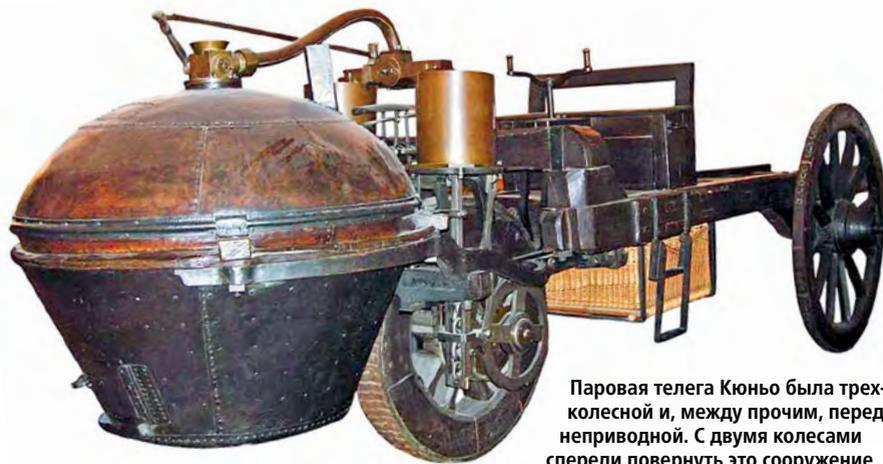
Паровая телега Кюньо была трехколесной и, между прочим, переднеприводной. С двумя колесами спереди повернуть это сооружение было бы уж совсем тяжело.
