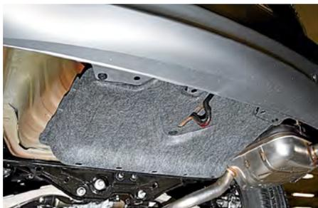
Под задним бампером – аэродинамический кожух. Буксировочные петли как спереди, так и сзади не рассчитаны на серьезную нагрузку.
