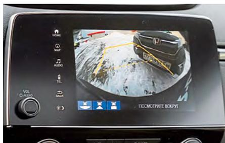
У камеры заднего вида три режима с различным углом обзора. Разметка-подсказка – динамическая.
