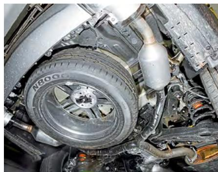
У Sorento ↑ и Grand Santa Fe → в длинном заднем свесе прячется полноразмерная запаска, ограничивающая угол съезда.
