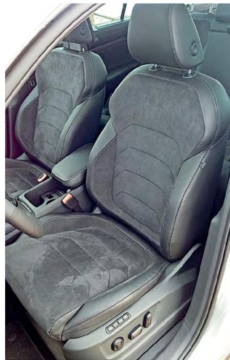
Передние сиденья можно установить предельно низко. Набивка анатомически жесткая, профили спинки и подушки хороши. Электропривод регулировок и память настроек на трех водителей – опция.
