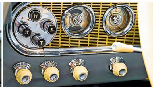
↑ Кнопочное управление коробкой передач – шик конца 1950-х. Режим **Т** – для тяжелых условий: когда не включается высшая передача. Режима парковки нет, так что о ручнике забывать нельзя ни в коем случае.
