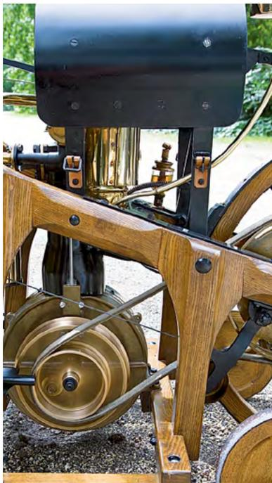
Мотоцикл Даймлера 1885 года, первый жизнеспособный экипаж с бензиновым мотором, на трехкилометровом отрезке достиг, как утверждали очевидцы, скорости 12 км/ч. Привод на заднее колесо – ремённый, но уже можно менять передачи!
