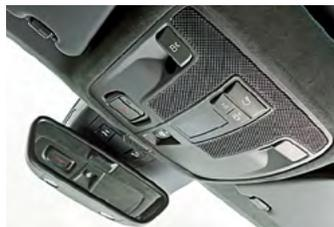
↑ В потолок встроен модуль ЭРА-ГЛОНАСС – «тридцатка» стала первым Infiniti с такой системой.
