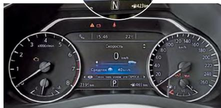
Между спидометром и тахометром с ясными шкалами – семидюймовый экран бортового компьютера.
