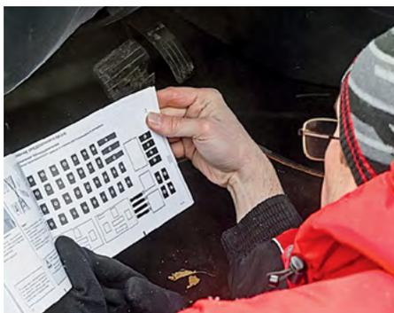
↑ Чтобы отключить ESP, вытаскиваем предохранитель. Нужный блок – в салоне, а не под капотом.
