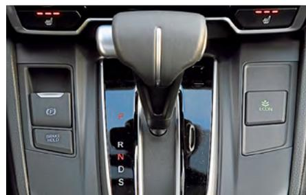
Электропривод ручника снабжен функцией Brake Hold для автоматического удержания автомобиля на месте во время остановок.
