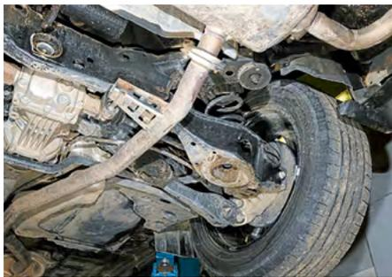
Нагромождение труб заметно уменьшает дорожный просвет Murano: под хитро выгнутым кронштейном системы выпуска – всего 185 мм.
