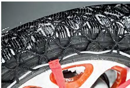
На первый взгляд, сетка – конструкция хлипкая: соединения прошиты обычными толстыми нитками.
