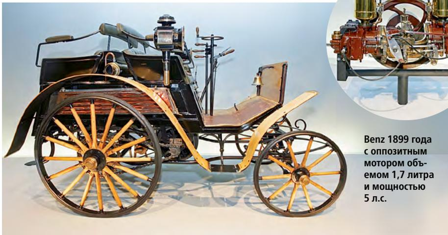
Benз 1899 года с оппозитным мотором объемом 1,7 литра и мощностью 5 л.с.
