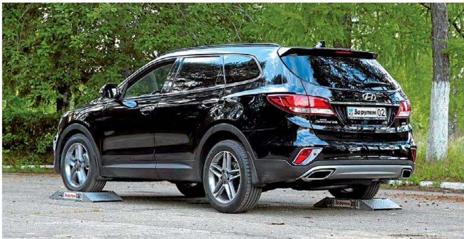
Grand Santa Fe поначалу без особых проблем справлялся с испытаниями на роликовых платформах, лишившись сцепления сперва под правым передним колесом, затем – под левым задним. Однако установка третьей роликовой площадки (под второе заднее колесо) напрочь обездвижила Hyundai. Аналогичным образом повел себя и соплатформенный Kia.
