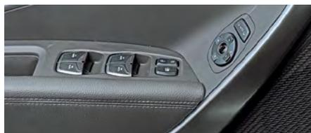
Компоновка клавиш на водительском подлокотнике необычна. Зато остановить стекла в автоматическом режиме можно нажатием кнопки в любую сторону.
