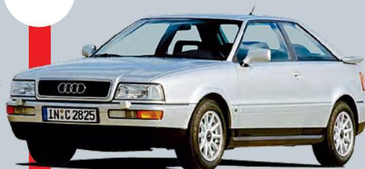
В 1988 году появилось следующее поколение Coupe – новинку построили на базе Audi 80 с кузовом B3. Моторы стали мощнее: двухлитровый развивал 136 сил, а 2,3-литровая «пятерка» выдавала 136 или 170 «лошадей». Была и полноприводная версия S2, в чреве которой билось 220-сильное «турбо-сердце», разогнавшее купе до сотни за 5,8 секунды.
